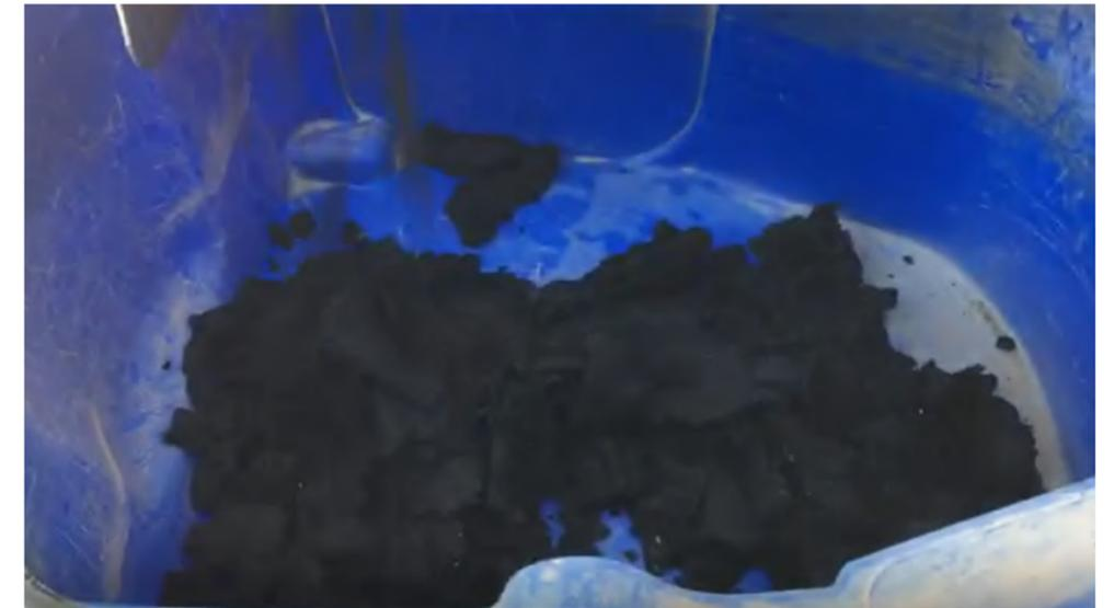
El resultado del agua es bastante bueno, por otra parte la torta también obtienen buenos resultados, se prensó en 4 milímetros la separación de la prensa.
